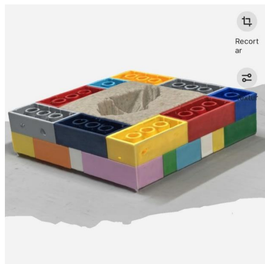
Resultado obtenido con la fotogrametría sin plato giratorio con Kiri Engine App. En la reconstrucción del molde se observan roturas en la malla.
